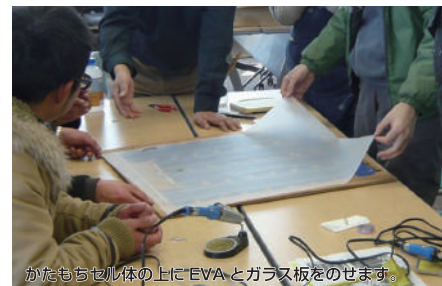
かたもちセル体の上にEVAとガラス板をのせます。
