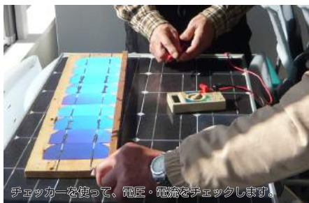
チェッカーを使って、電圧・電流をチェックします。
